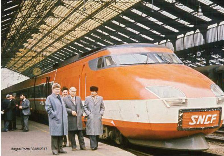
TGV : il manque quelque chose sur ce TGV, je ne sais pas si vous l'avez vu, il n'y a pas de pantographe sur le TGV, parce que c'est le prototype du premier TGV et il devait rouler avec une turbine à gaz mais le choc pétrolier est arrivé, et du coup, on a dit « on va aller sur l'électricité, on va développer le nucléaire, et on sera moins dépendant comme ça ».
