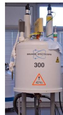
RMN 300 MHz équipé de sonde QNP et d'une sonde sélective ^{19}\text{F}
