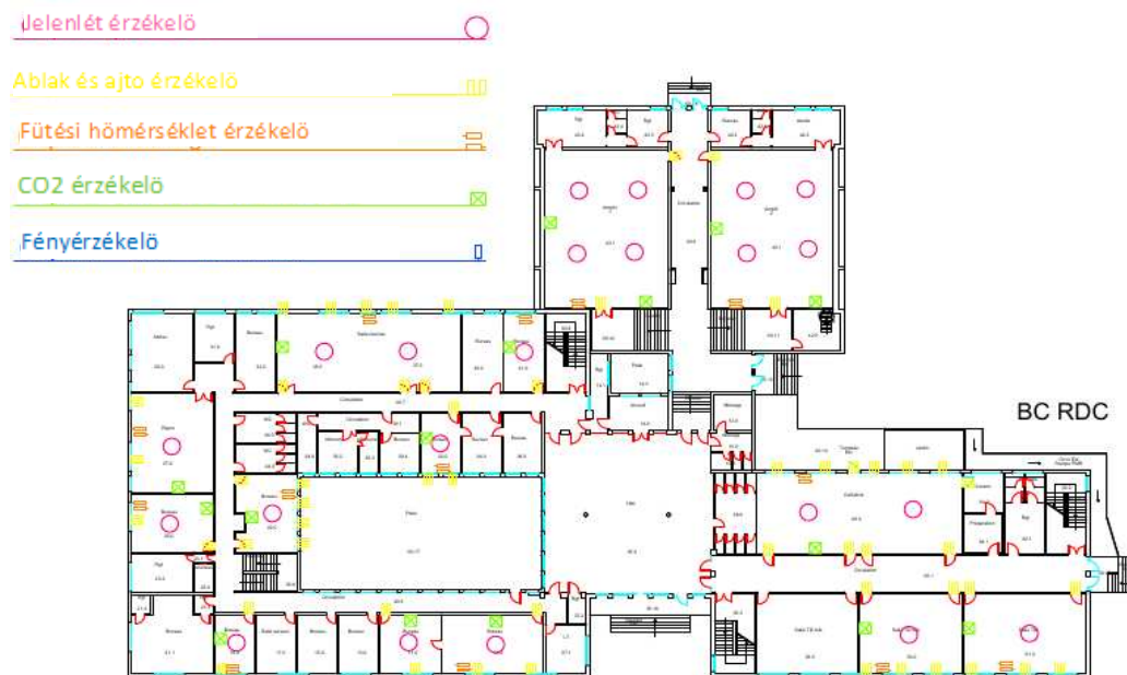
Az érzékelők elhelyezése a központi épületben
