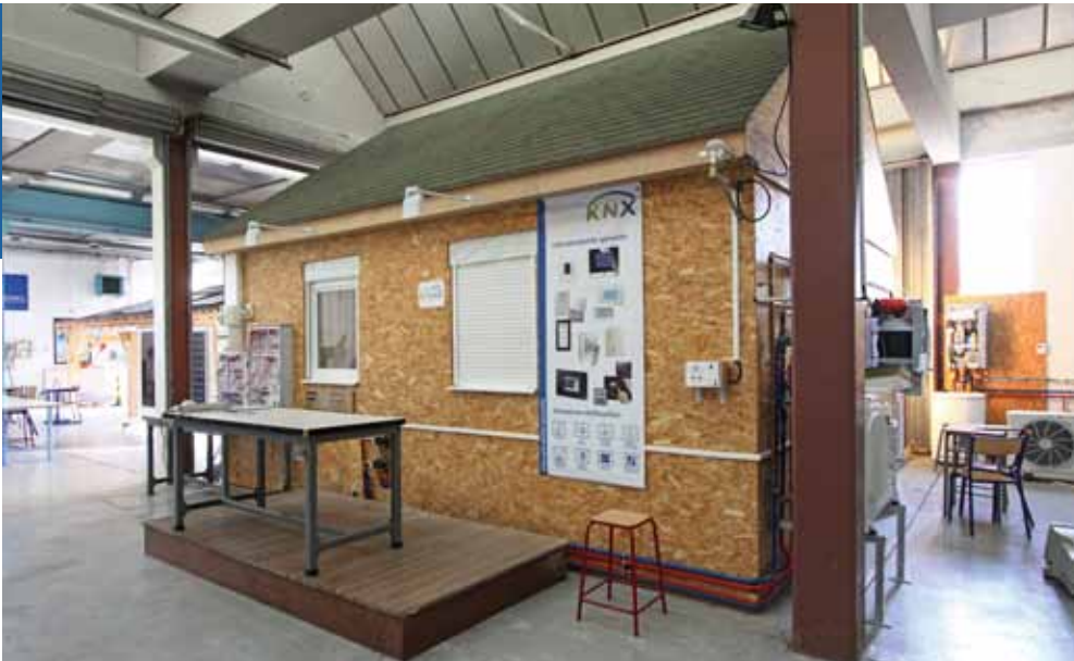
LA MAISON EXPÉRIMENTALE DE L'IUT PERMET DE TESTER MATÉRIAUX ET NOUVELLES TECHNOLOGIES DE LA CONSTRUCTION ET DE SES ÉQUIPEMENTS
